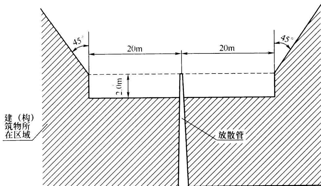
图6.4.20 放散管允许最低高度示意
